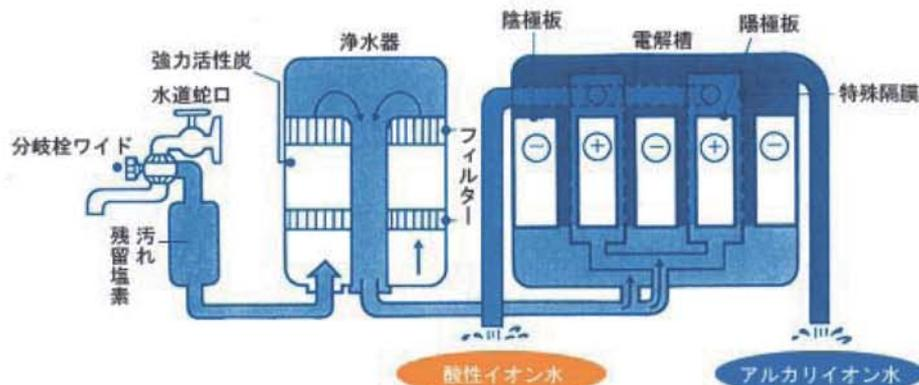
水道水を浄水フィルターでろ過し、さらに電気分解した水を電解水(アルカリイオン水・酸性イオン水)といいます。
